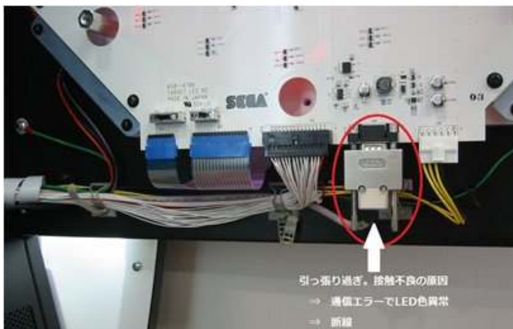
写真 ; コネクタ内部断線例
