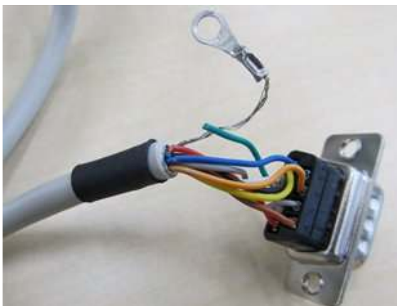
写真 ; コネクタ内部断線例
