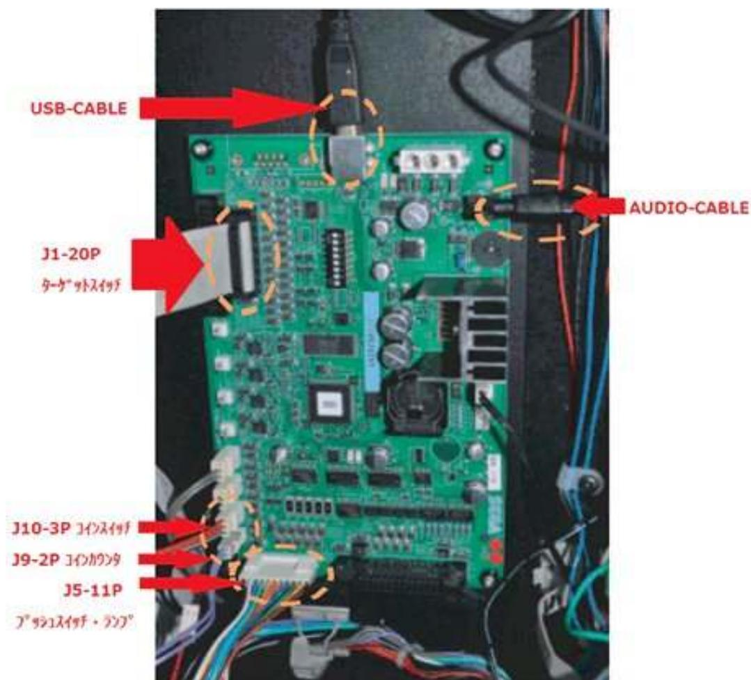
写真 ; ↓ EX-F(MATRIX)のJ9-2P (コインカウンター)
