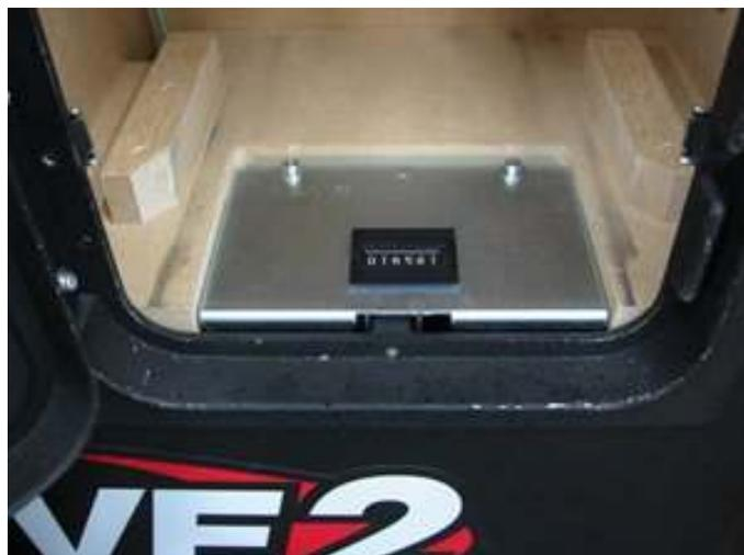
写真 ; ↓ Spectrum のコインメーター部
