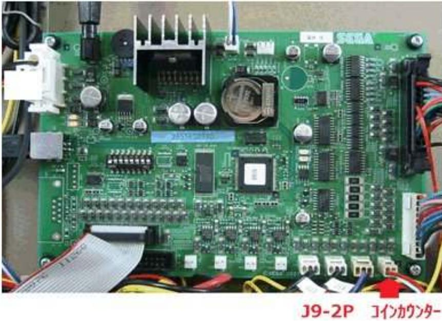
写真 ; ↓ EX/DX のJ9-2P (コインカウンター)
