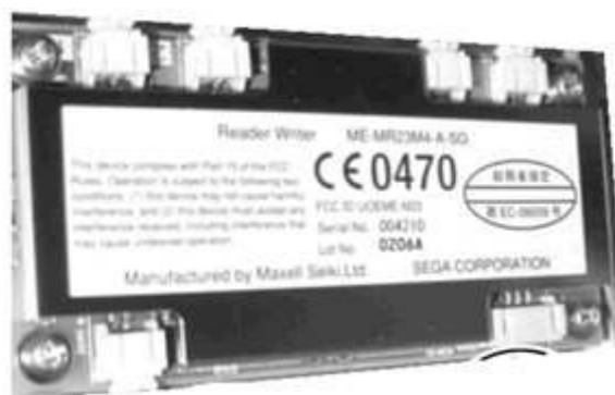
写真; DL2 カードリーダー制御基板
